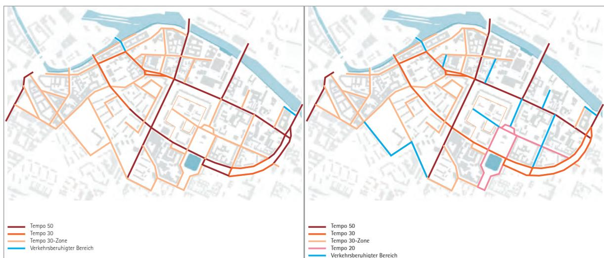
**Abbildung 9-7** Geschwindigkeitskonzept | Vergleich Bestand (links) und Planung (rechts)
